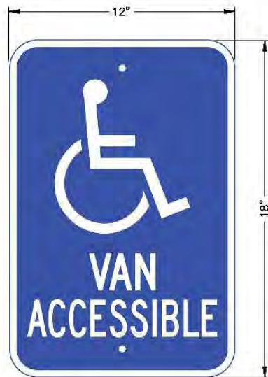
ACCESSIBLE-VAN ACCESSIBLE SIGNAGE DETAIL 2 SCALE: N.T.S.
